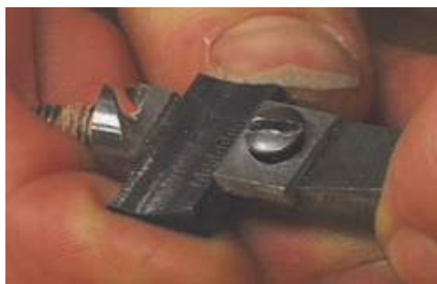
lâmina que desliza na cavidade do corpo da broca
